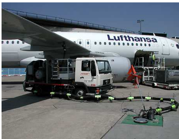
Distributore dell'idrante di carburante collegato in un posto di rifornimento sotto l'ala di un aereo.
